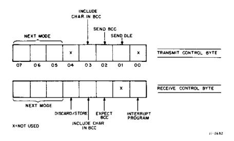
Figure 3-2 Control Byte Formats
